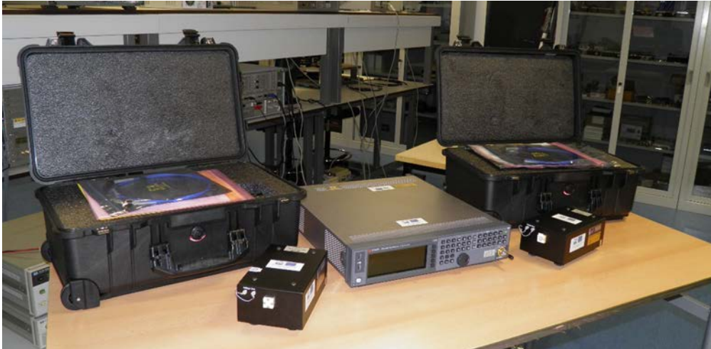
Figura 1.- Equipo Generador de Ondas Milimétricas. Consta de un generador de 100 kHz a 40 GHz y de dos módulos multiplicadores de frecuencia. Los maletines son para el transporte de los módulos multiplicadores.
