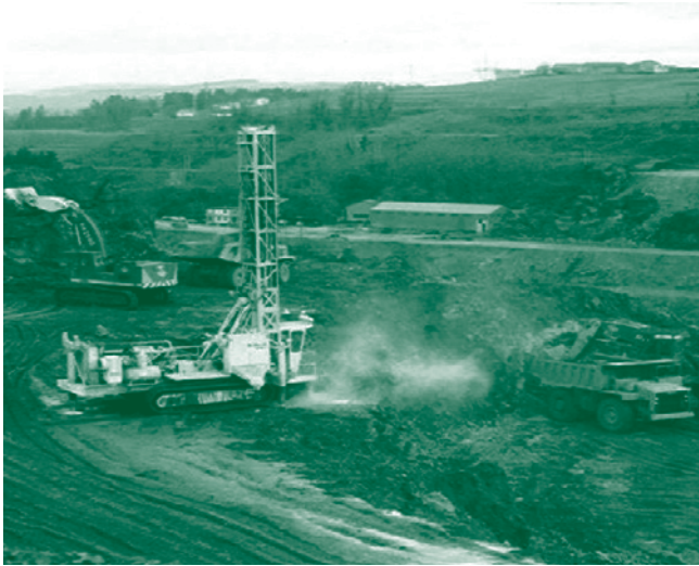
Fotografía 5. Una Drilltech D-50K trabajando en las labores de perforación para la voladura.
