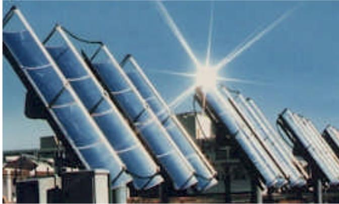
Figura E.11. Concentradores Cilíndrico-Parabólicos.
