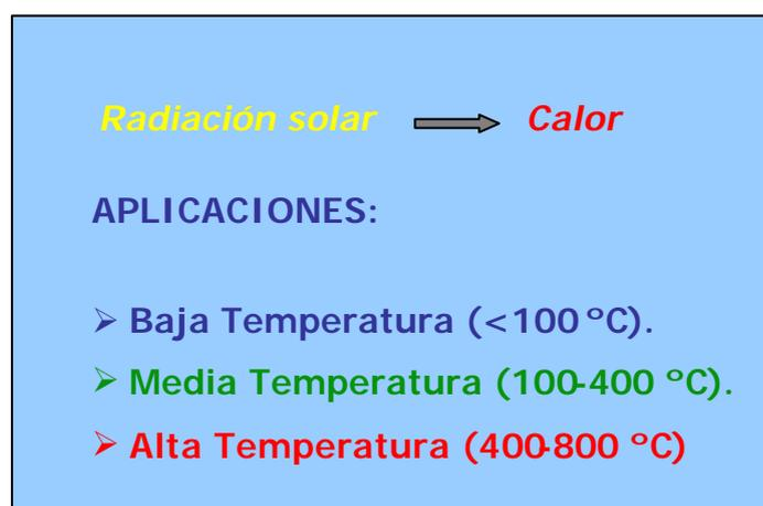
Figura E.9. Clasificación de los sistemas solares térmicos.
