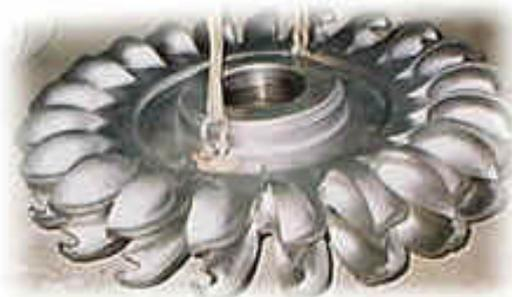
Figura E.18. Turbina Pelton.
