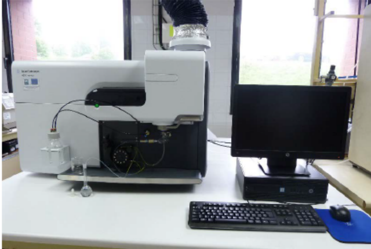
1. Equipo instrumental de espectroscopía de emisión atómica de plasma por microondas (MP-AES)
