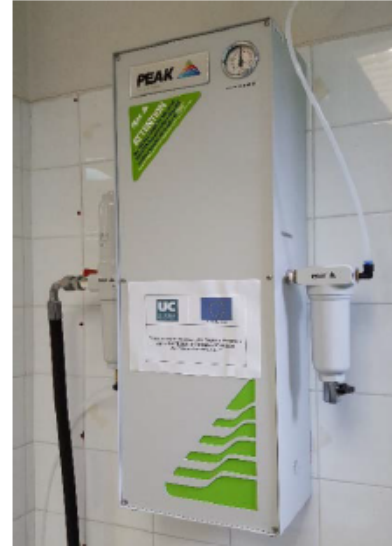
2. Generador de nitrógeno gas mediante tecnología de membranas
