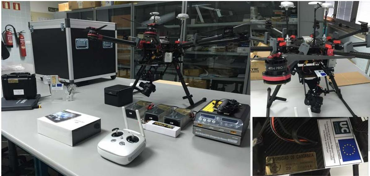
Figura 1: Equipo Vehículo Aéreo No Tripulado para el estudio de procesos geológicos terrestres superficiales con los accesorios
